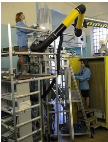
Рис. 2 Участок армирования дрейфовых трубок.
