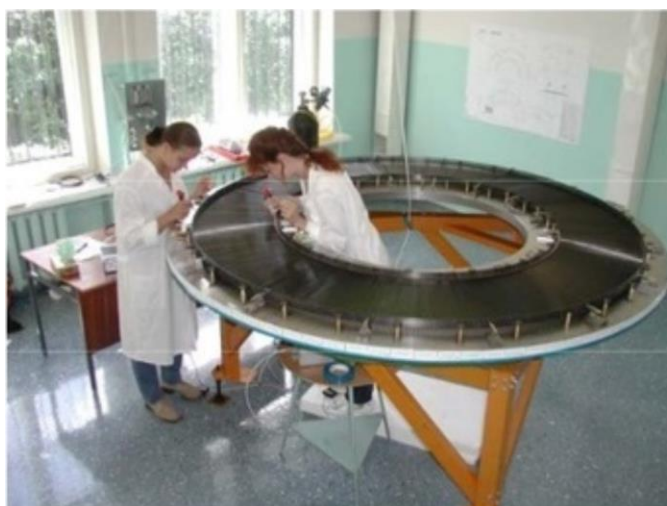
Рис. 4 Сборка модулей детектора TRT в ПИЯФ. Установка и вклейка трубок в поддерживающие
