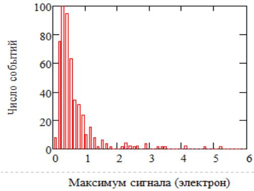
Рис.12. Распределение наибольших значений перекрестной наводки,  $R1, R2 = 50 \text{ Ohm}$ .
