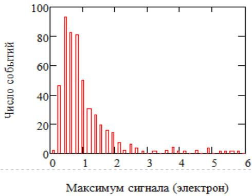
Рис.11. Распределение наибольших значений перекрестной наводки,  $R1, R2 = 100 \text{ Ohm}$ .
