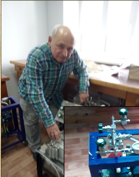
Установки по очистке гелий - 3 и бустер по его перекачиванию до P=100\text{Атм}
