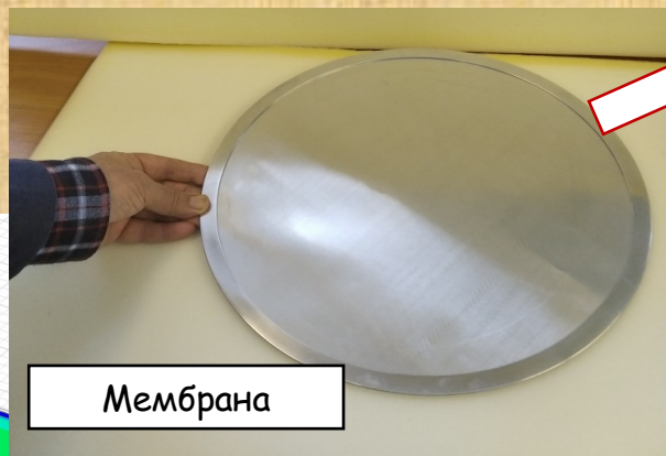
Мембрана \varnothing 320 \times 0,1 мм и решетка
