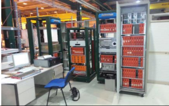
Тестовый стенд в ЦЕРН для проверки и отладки модулей UF/PNPI HV System
