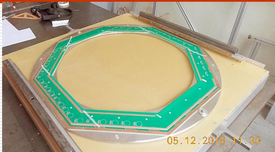
Анодная плоскость. Апертура 600 мм. W/Re 30  $\mu\text{m}$  проволоки, шаг 3 мм
