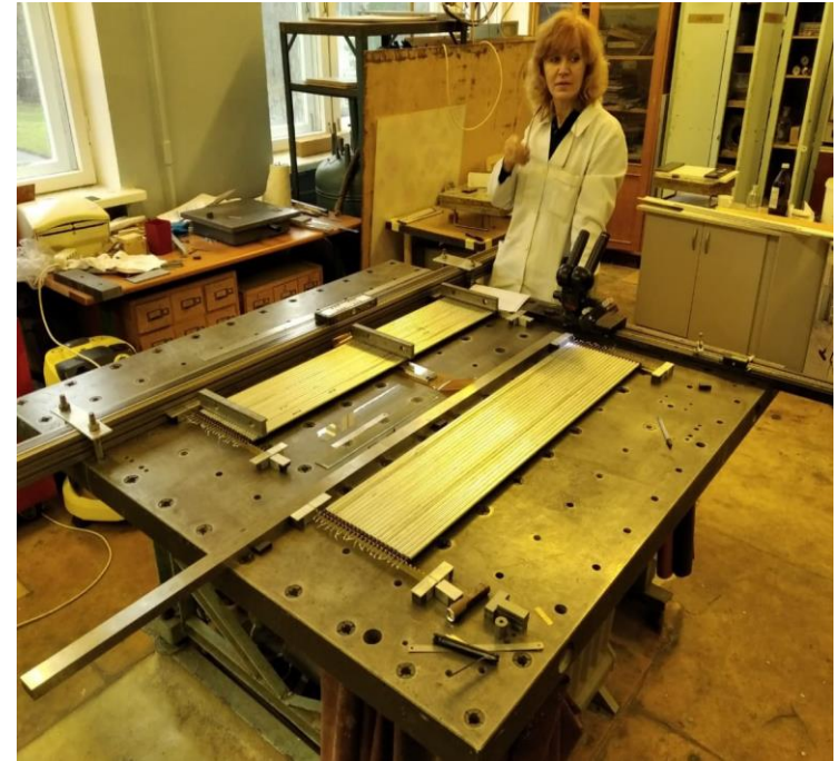
Сборка трубок станции X2 спектрометра PAS
