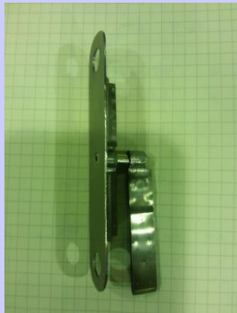
Ионный источник поверхностной ионизации с вольфрамовой трубкой длиной 20 мм из монокристаллического вольфрама с работой выхода 5 эВ
