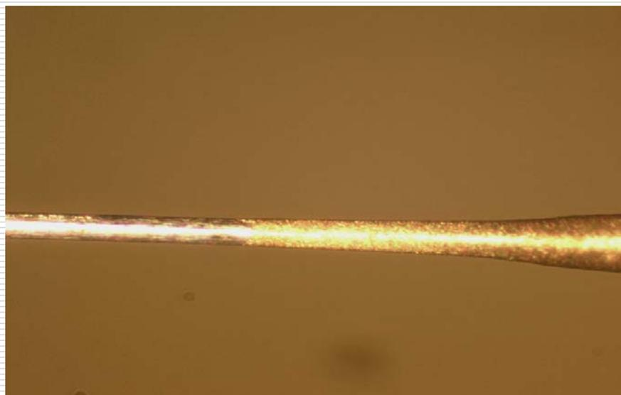
Катодная проволока W/Re 50  $\mu\text{m}$ . Нарращивание золота на центральной части 50  $\mu\text{m}$   $\rightarrow$  80  $\mu\text{m}$ . Увеличение 100. Сорока М.А. Гаврилов Г. Е.
