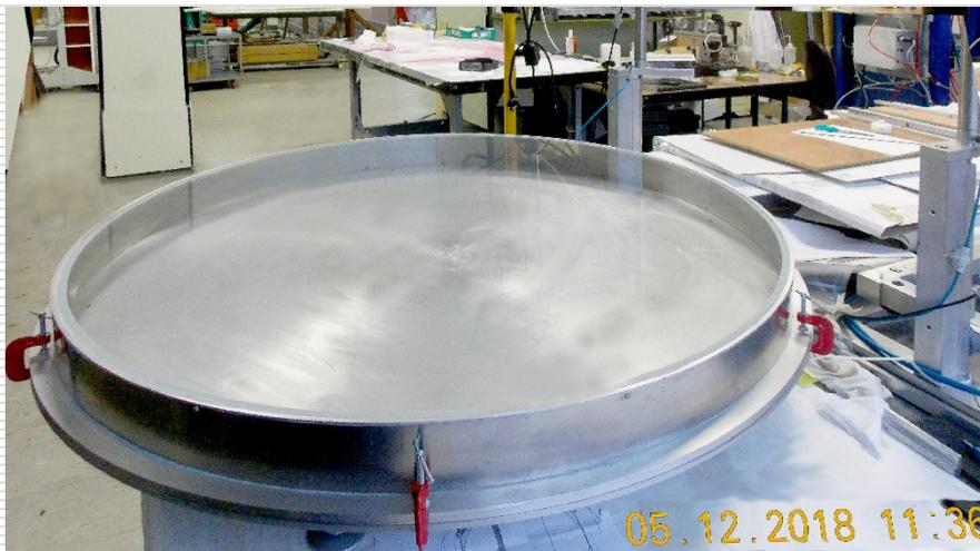
1000 мм камера для тестов на Ar/CH<sub>4</sub> смеси при атмосферном давлении
