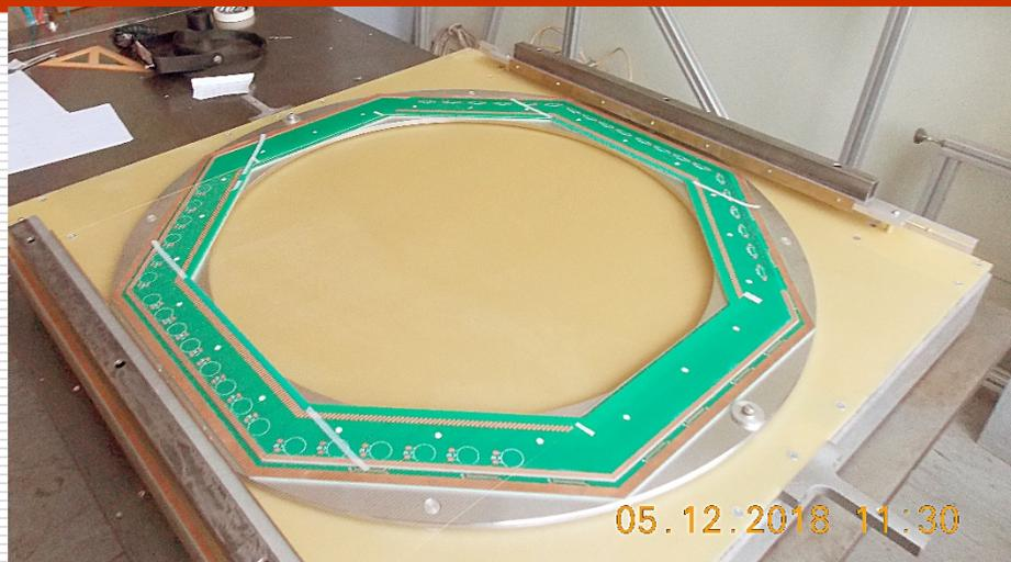
Анодная плоскость. Просвет 600 мм. W/Re 30  $\mu\text{m}$  проволока, шаг 3 мм. Бочин Б.В.
