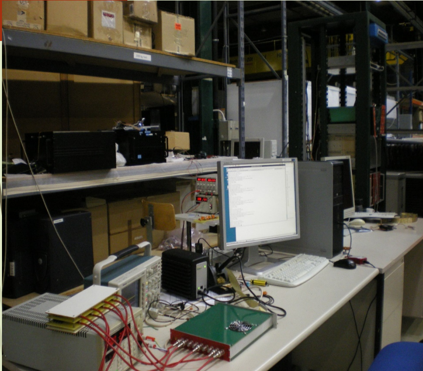
Стенд для калибровки высоковольтных модулей (CERN, BLD.904)
