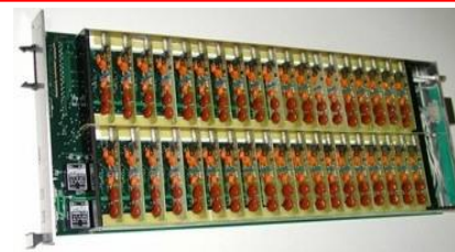
DB36 (30)Дистрибутор на 30 или 36 каналов Понижающее регулирование ~1KV Выходной ток 100 мкА на канал Измерение тока и напряжения
