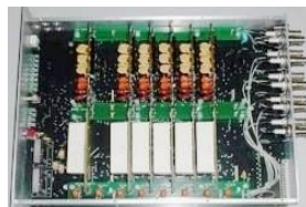
МВ- 8-канальный Мастер-дистрибутор Регуляторы 0-4 кВ (0-3 кВ - LHCb) 1.5 мА выходной ток на канал Измерение тока и напряжения
