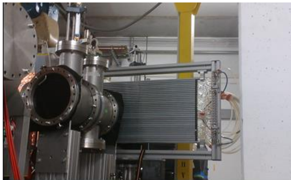
Рис. 5. Пучковые испытания PAS-прототипа в GSI
