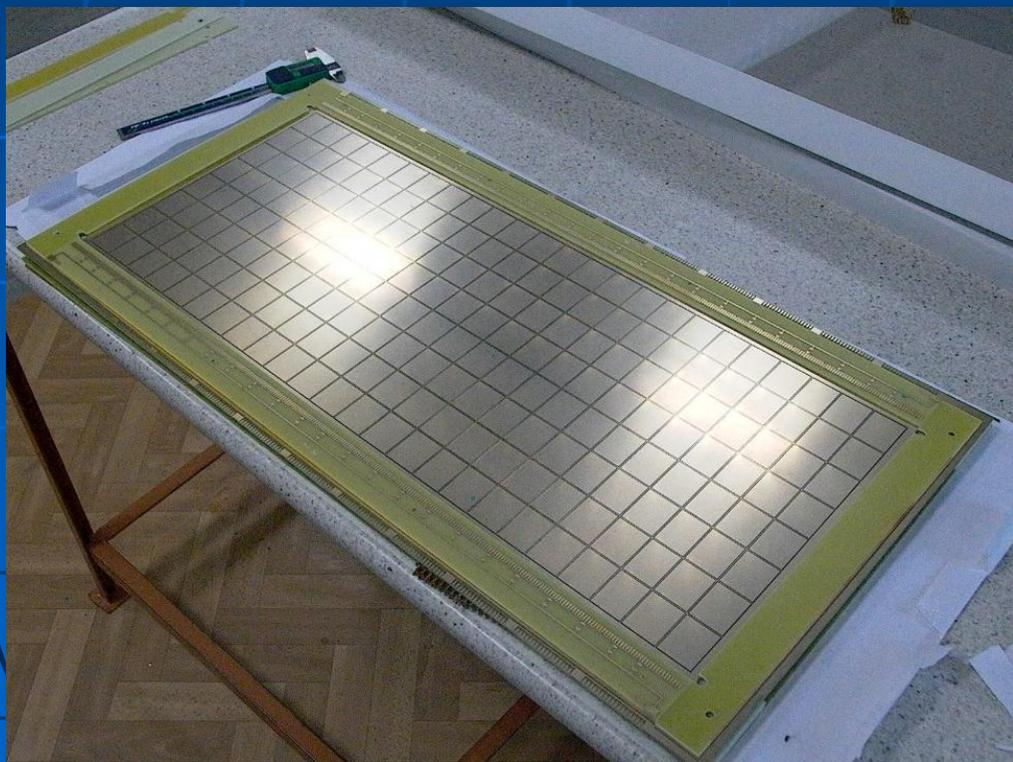
К настоящему времени изготовлена часть деталей для первого прототипа камер M2R2. Здесь площадь физического пада равна площади логического пада, геометрически этот пад в 2 раза ниже, но в 2 раза шире. Как показывают расчеты такая геометрия падов наиболее оптимальная как по эффективности, так и по FOI.
