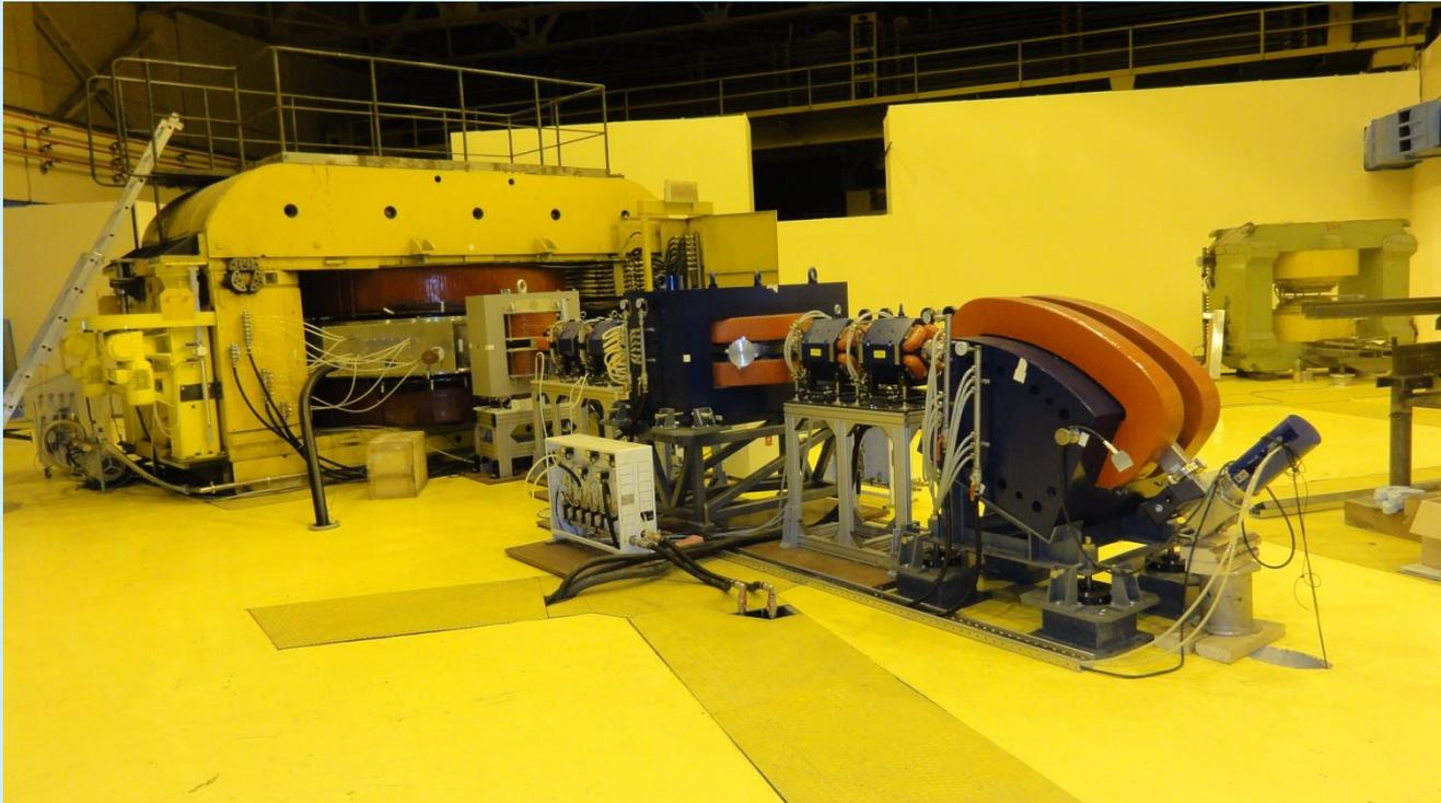
Изготовлены три протонных тракта к мишеням РИЦ-80.
