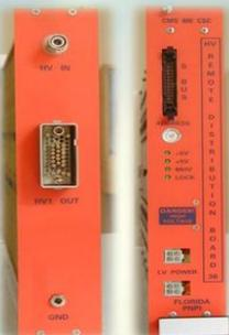
Система на 2500 каналов предназначена для обеспечения высоковольтным питанием камер ME 4/2 EMU CMS
