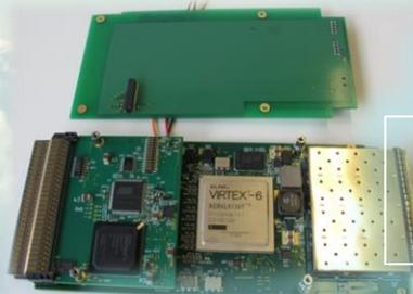
AMC13 – заказной модуль, обеспечивающий TTC- сигналы и взаимосвязь с системами TTS и DAQ
