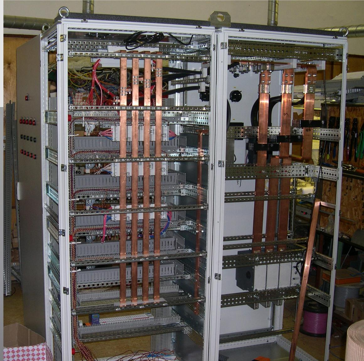
Изготовлены стойки автоматизированной системы управления.
