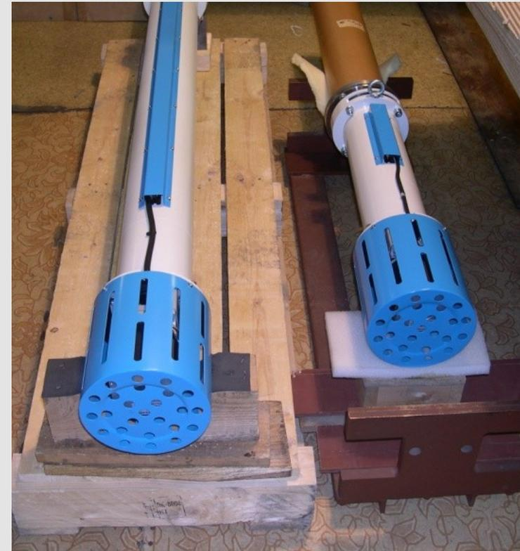
1. Изготовлен и проверен диагностический блок с цилиндром Фарадея и датчиком плотности пучка.
