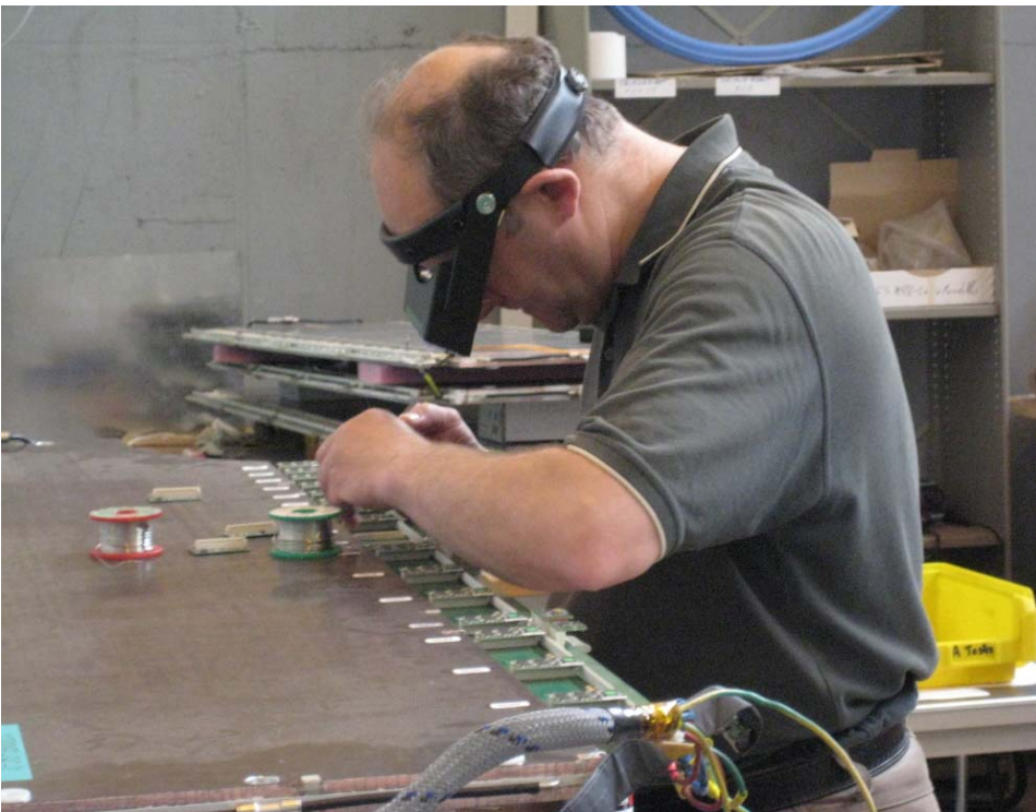
Ремонт трекового модуля
