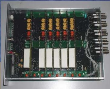
*Система предназначена для высоковольтного питания многосегментных камер
