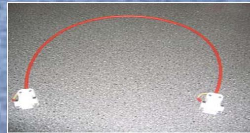
Высоковольтный кабель с двумя 5-контактными разъёмами
