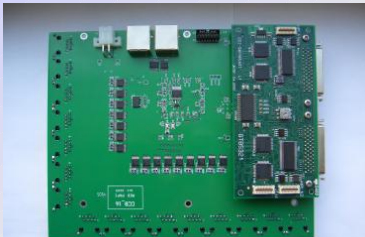
Плата концентратора CCB_16 с установленным адаптером GTB- интерфейса
