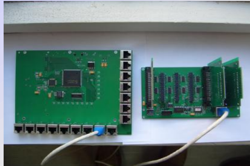
Системный концентратор ССВ_16 и системная детекторная плата CDR_96 с с кабелем 5CAT
