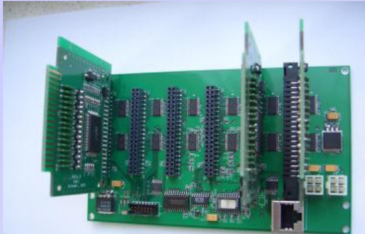
Системная детекторная плата CDR_96 с установленными платами AD_16
