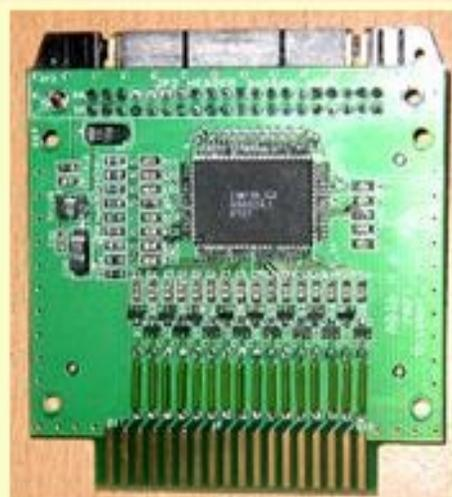
*CROS3 – прототип координатной системы считывания, разрабатываемый с 2003*
