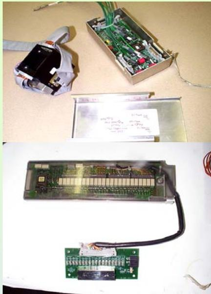
*Система предназначена для контроля и мониторинга положения детекторов экспериментальной установки CMS . Использует оптические позиционные сенсоры, мониторирующие положение прямой линии лазера*
