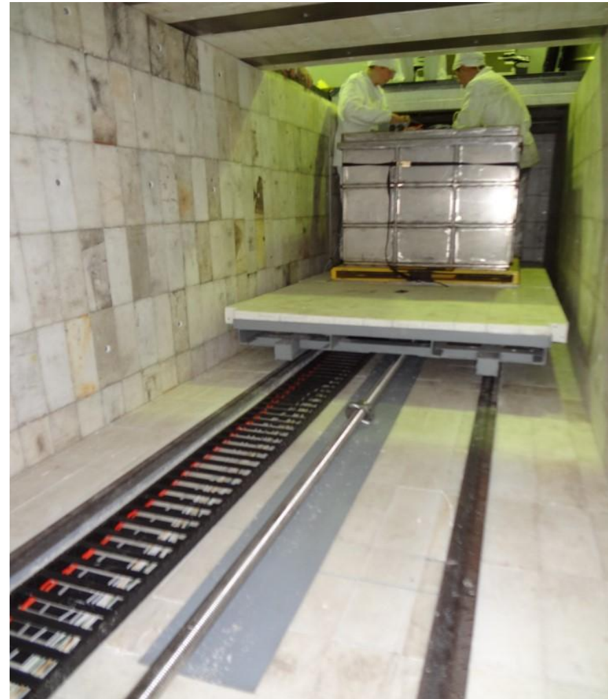
Диапазон измерений потока реакторных антинейтрино 6-12м
