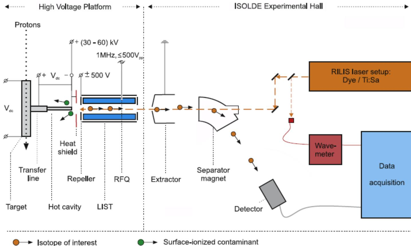
Снижение фона поверхностной ионизации:  $\sim 10^4$
