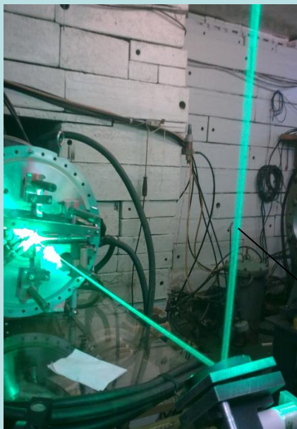
Ультрафиолетовый и зеленый лазерные лучи, сфокусированные в объем лазерного ионного источника
