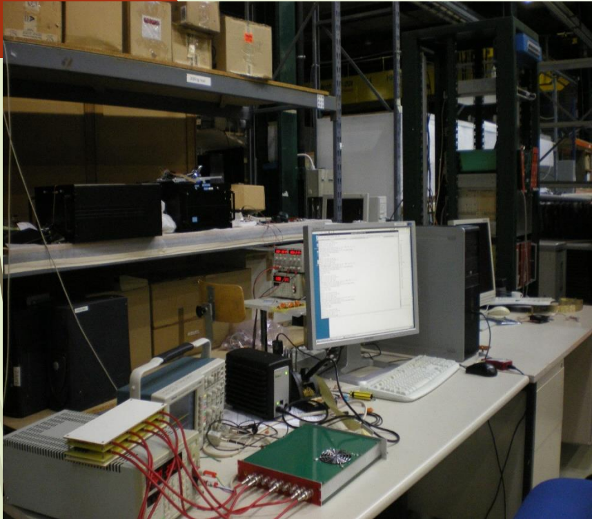
Стенд для калибровки высоковольтных модулей (CERN, BLD.904)
