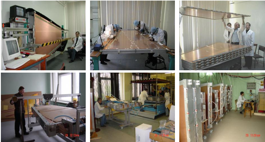
Иллюстрация процесса изготовления мюонных камер.
