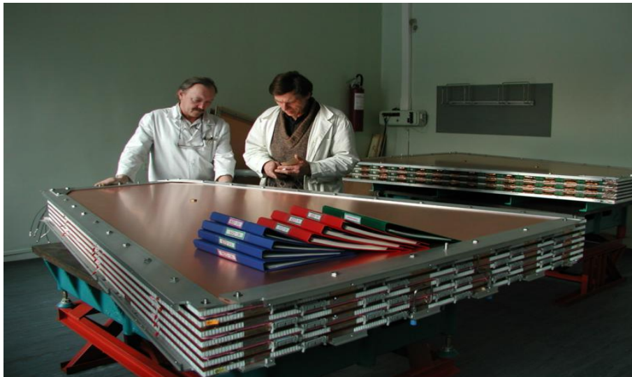
Иллюстрация процесса изготовления мюонных камер.
