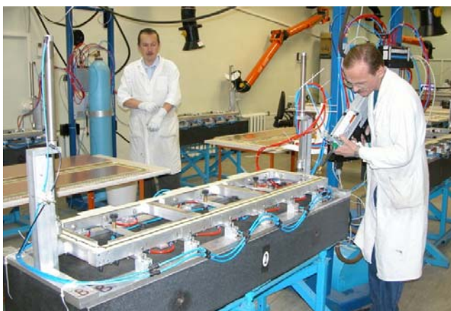
Рис. 6 Устройство для прецизионной приклейки баров к панелям.
