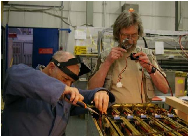
Рис.17. Подготовка мюонных камер к испытаниям. Установка прикамерной электроники.
