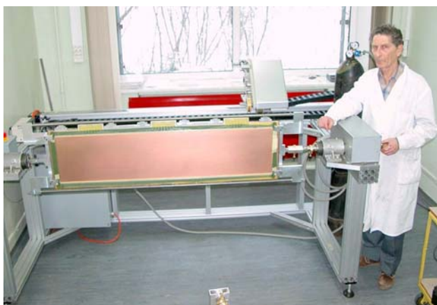
Рис. 7. Автоматизированная намотка анодных проволок.
