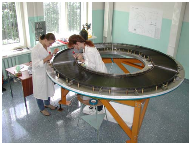
Рис. 4. Сборка модулей детектора TRT в ПИЯФ. Установка и клейка трубок в поддерживающие углепластиковые кольца.
