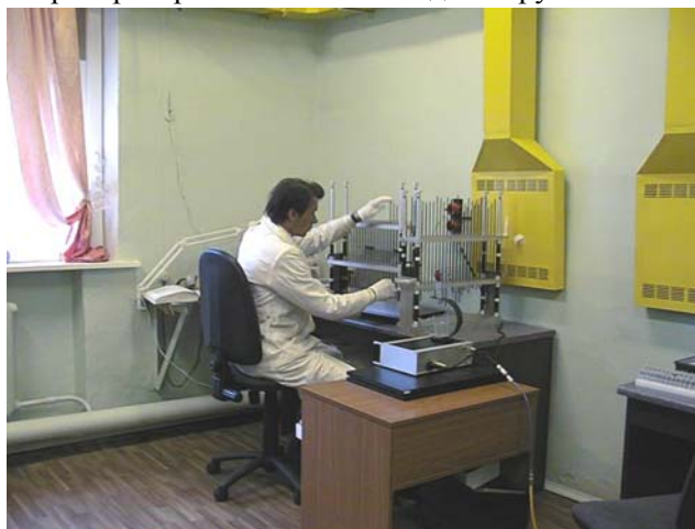
Рис. 3. Участок по подготовке дрейфовых трубок для сборки модулей детектора TRT в ПИЯФ.
