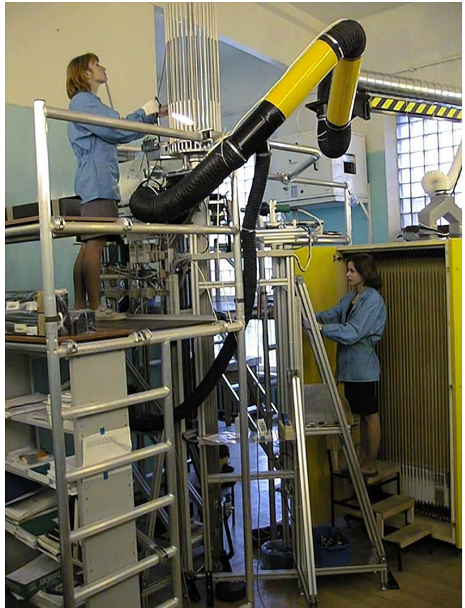
Рис. 2. Участок для армирования дрейфовых трубок (Straw Reinforcement Machine).
