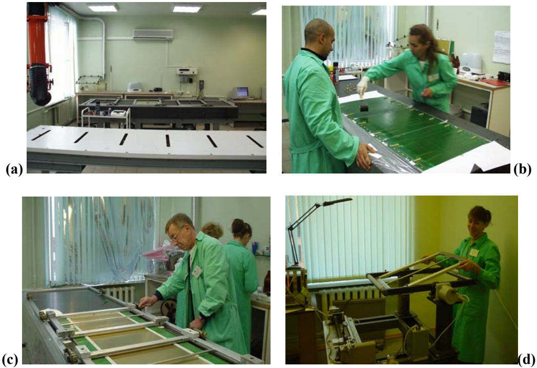
Рис. 7. Вид чистой сборочной комнаты (а), процесс приклеивания печатных плат к композитным сэндвичам (b), машина для намотки проволоки (d), и процесс установки сигнальных проволок на каркас (с).
