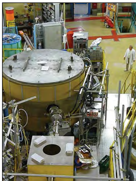
Спектрометр НИЦ КИ ПИЯФ для поиска ЭДМ нейтрона на пучке ультрахолодных нейтронов реактора ILL
