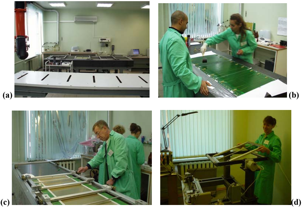
Рис. 7. Вид чистой сборочной комнаты (а), процесс приклеивания печатных плат к композитным сэндвичам (б), машина для намотки проволоки (д), и процесс установки сигнальных проволок на каркас (с).
