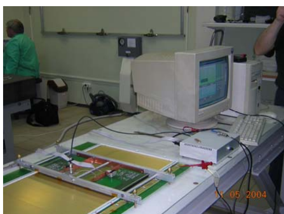
Рис. 5. Оборудование для измерения натяжения проволок и распределение натяжения, измеренное для примерно 20000 проволок в камерах, изготовленных в ПИЯФ.
