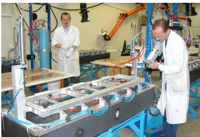
Рис. 6 Устройство для прецизионной приклейки баров к панелям.
