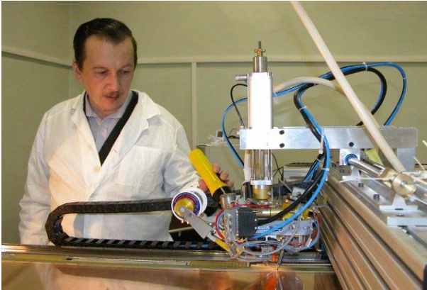
Рис. 8. Автоматическая пайка анодных проволок.
