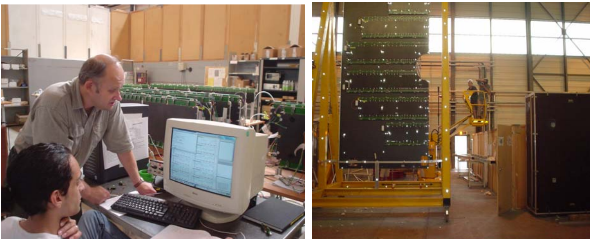
Рис. 8. Тесты трековых камер (слева) и собранная половина трековой станции (справа) в ЦЕРН.
