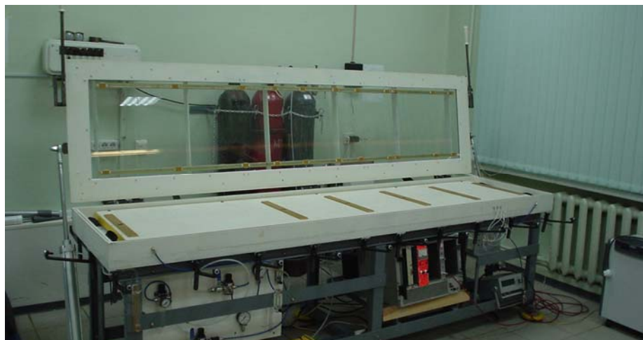
Рис. 4. Вид стенда для тестирования при высоком напряжении.
