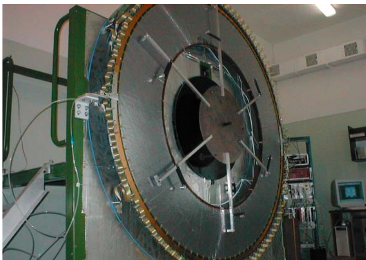
Рис. 6. Вид 8-слойного модуля, подготовленного для теста на стенде WTS (Wheel Test Station) с радиоактивными источниками 55 Fe.
