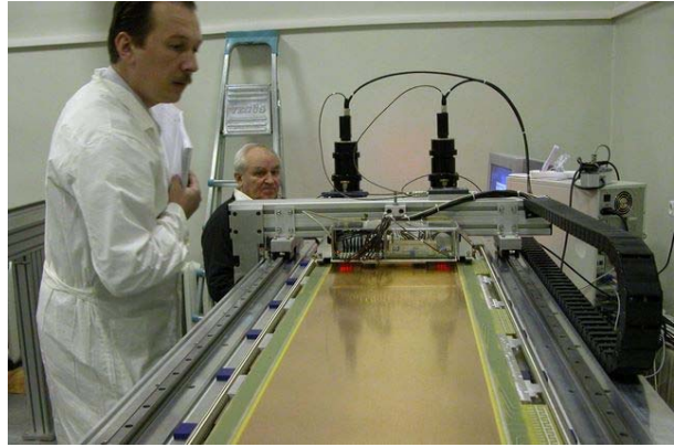
Рис. 9. Автомат для измерения натяжения анодных проволок и расстояния между ними.
