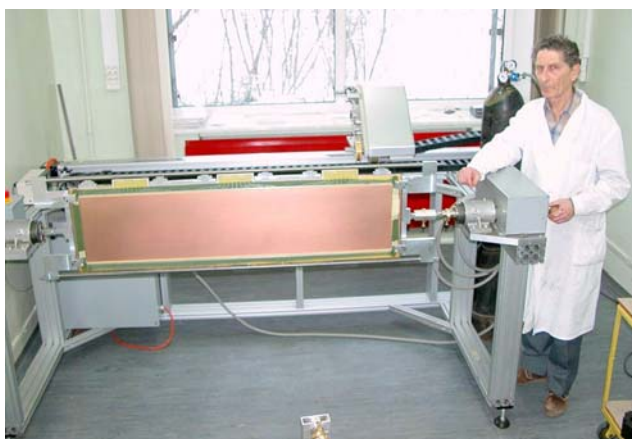
Рис. 7. Автоматизированная намотка анодных проволок.
