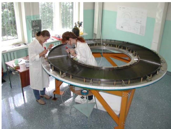
Рис. 4. Сборка модулей детектора TRT в ПИЯФ. Установка и клеивка трубок в поддерживающие углепластиковые кольца.
