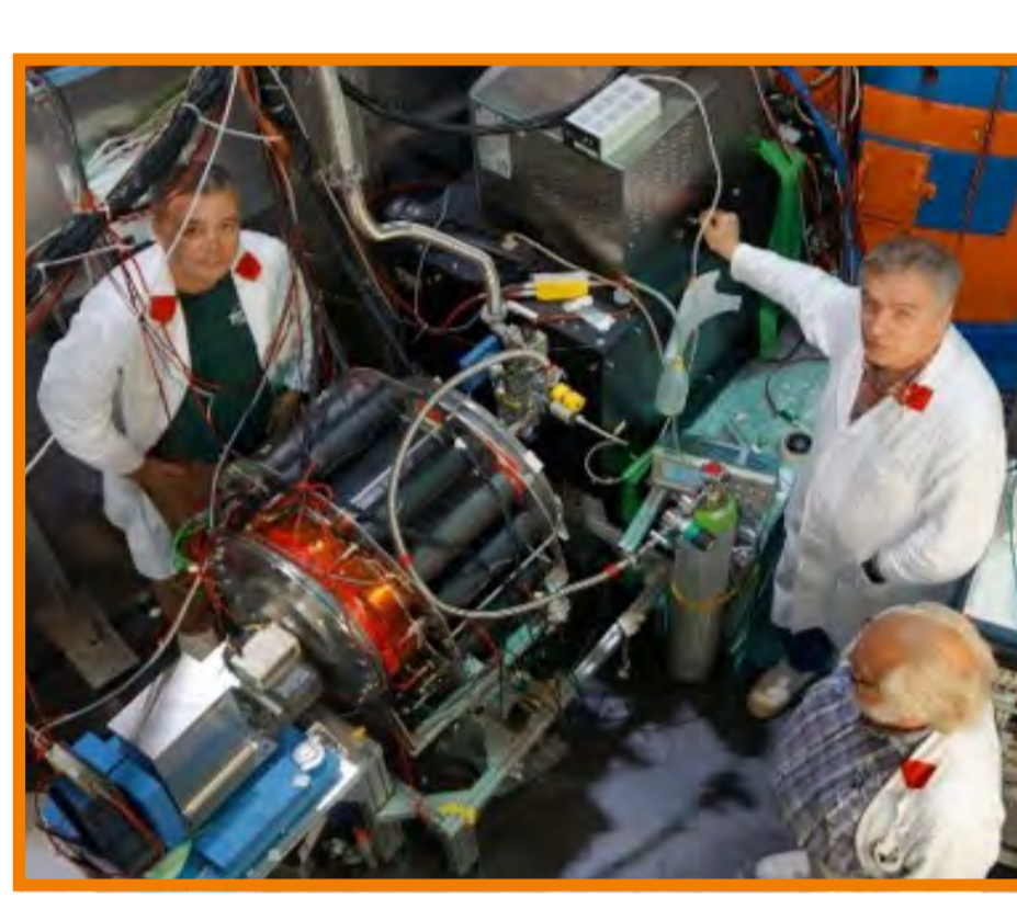
Установка для исследования ROT-эффекта для \gamma -квантов при делении ^{235}\text{U} поляризованными нейтронами
