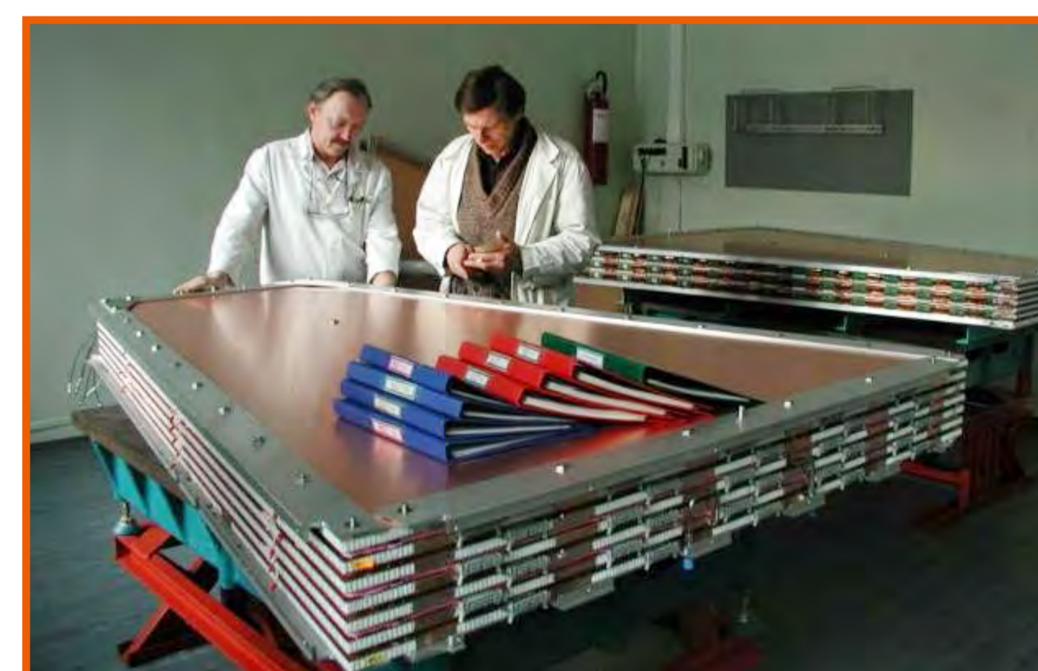
Одна из 120 мюонных камер CMS готовится к испытаниям (октябрь 2005 г.)
